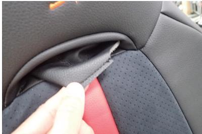
13 ヘッドレスト下の空洞部分にカバーを固定します。
