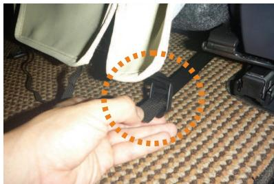
10 引き出したベルトを4番で引き出した生地に付いているバックルに通して固定します。
