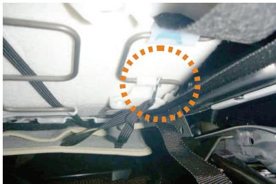
15 金属フックはシート裏の金属部分に引っ掛けで固定します。
