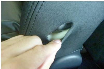
4 ③番で開けた穴から内側を見て、シート表皮の穴と同様の大きさまで生地を切り取ります。③番で開けた穴の大きさでは、アームレストの可動時に強い生地同士の摩擦が生じますので、必ず行って下さい。
