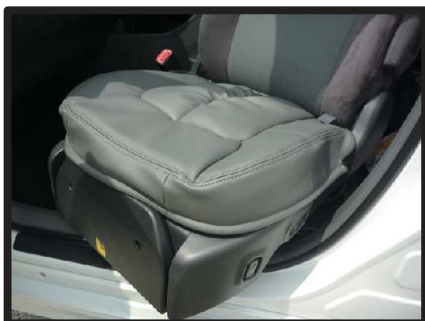
②シートラインからずれないようにカバーをシート全体にかぶせます。
