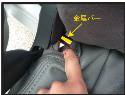
⑥ベルトを座面の付け根部分にある金属バーの手前の隙間に落とし込みます。
