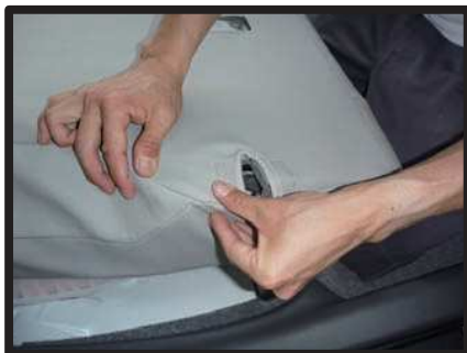
⑰ 背もたれを固定する金具をかわしてマジックテープをシート本体に貼り付け固定します。
