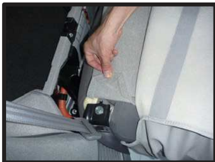
⑦背もたれの背面にある角の部分も折り込みカバーの中に入れ込みます。
