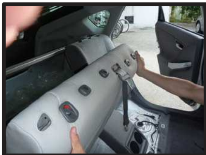
⑬リクライニングボタン、ヘッドレストの台座を取り出した写真です。
