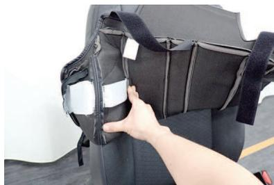
4 シートカバーをシートに取り付ける際は、シートカバーを半分ほど裏返し、シートのサイドエアバッグ展開部分とカバーのSAB対応の縫い目部分を合わせてから、カバーを装着します。
