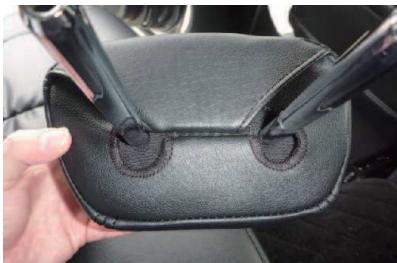
**14** ヘッドレストを台座から取り外し、カバー底面のプラフックを固定します。
