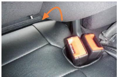
7 10ページ6番と同様に、シートベルト付近のシートの角を包み込むように、カバーをかぶせます。
