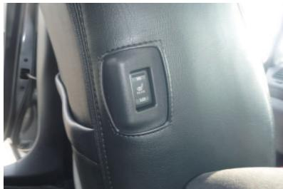
15 助手席背もたれは、図のようにシートヒーター用スイッチが使用出来るよう、カバーに穴開け加工がされています。
