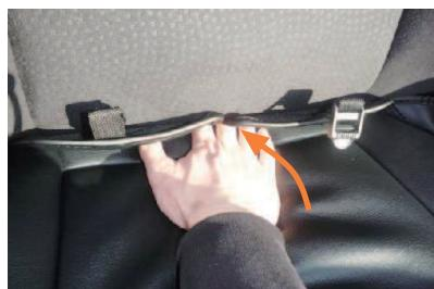
5 背もたれと座面の隙間に生地を入れ込みます。背もたれの角度を調整して入れ込みやすい角度で行って下さい。
