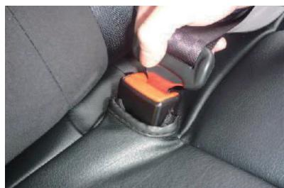
9 助手席側のシートベルトをバックルに装着します。
