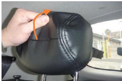
8 2列目左右席ヘッドレストは、カバーを前側から後ろ側へかぶせるようにします。
