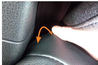
6 シート外側面の背もたれ付け根側の角を包み込むように、カバーをかぶせます。
