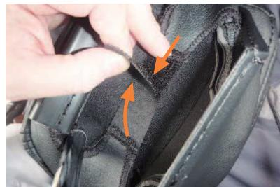
10 ヘッドレストを台座から取り外し、カバー底面の左右に付いているマジックテープ同士を内側へ寄せながら固定します。
