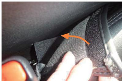
7 シート内側面の生地に付いているマジックテープを、シートに直接固定します。
