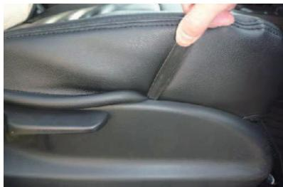
8 シート外側面の生地をプラスチック部の隙間に入れ込みます。
