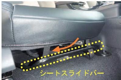
9 カバー前面に付いているベルトを、シートスライドバーの上側を通し、後ろ側へ引き出します。
