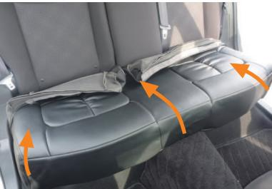
1 シートの前側に引っ掛けるように、カバーを矢印方向にかぶせます。
