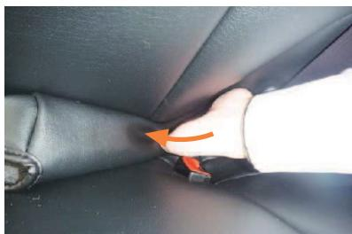
8 背もたれと座面の隙間に生地を入れ込みます。背もたれの角度を調整して入れ込みやすい角度で行って下さい。
