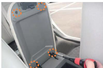
1 アームレストのフタを開け、図の○位置のネジを、プラスドライバーで取り外します。
