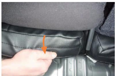
8 かぶせたカバーにはマジックテープが付いていますので、シート背面側に直接固定します。
