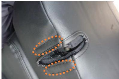
7 カバー外側面の生地にはマジックテープが付いていますので、図のようにシートの穴位置に合わせ、直接固定します。
