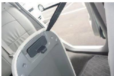
2 アームレストの隙間にヘラ等を差し込み、隙間を広げるようにすると固定しているツメが外れます。
