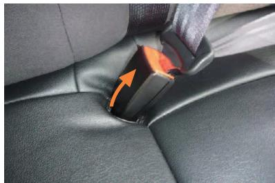
10 9番の状態で、シートベルトをバックルごとカバーの加工穴から引き抜きます。
