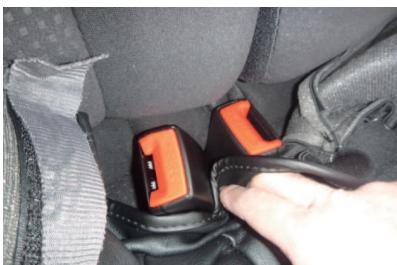
3 シートベルト収納部の形状に合わせて、カバーを入れ込みます。
