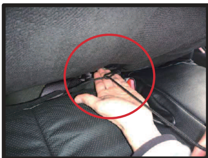
⑨ヒモは座面裏を通し結び留めます。片方のヒモで輪を作り、もう片方のヒモをその輪に通して絞り込んで結び留めます。※図は分かりやすいようにヒモを表に出しています。実際は座面裏で結び留めます。
