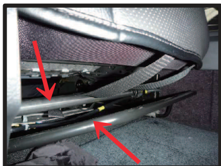
⑪ベルトはシート裏を通し、シート背面へ回します。この際、図の矢印部分のリクライニングレバー、運転席のみ金属バーの上を通すようにして下さい。
