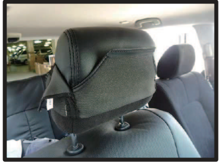
①ヘッドレストカバーは平らなプラスチック部品が付いている方が前にあります。 1列目ヘッドレストです。カバーを半分ほど裏返して、ヘッドレストのラインに合わせてかぶせます。
