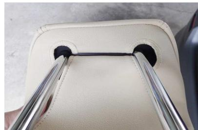
10 ヘッドラストをシートから外し、ヘッドラスト裏で、1列目と同様にプラスチックバーでカバーを固定します。
