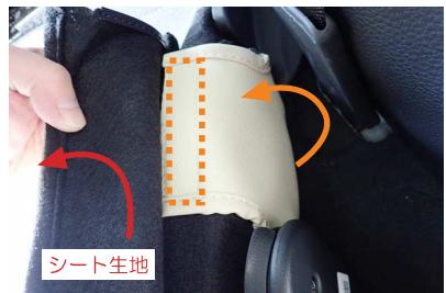
21 背面のシート生地をめぐり上げ、20番で通した生地を、マジックテープで直接シートに貼り付け固定します。
