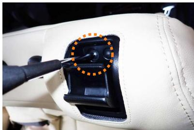
7 肩口のリクライニングレバーを引いた状態にすると、中にネジが見えますので、プラスドライバーを使用しネジを緩めます。
