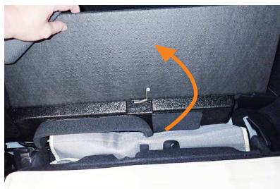
12 シートを倒した状態で、背もたれ背面にあるプレートをめくり上げます。
