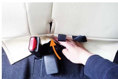
11 座面を跳ね上げた状態で、カバー下側の生地を、背もたれと車体の隙間に入れ込みます。
