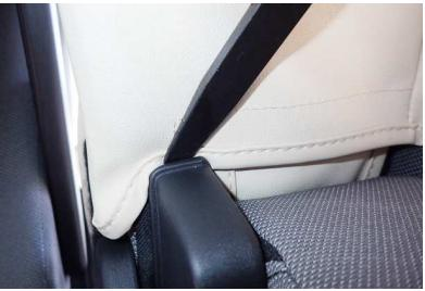
19 アームレストのヒンジ部（プラスチックバーツ）の隙間に生地を入れ込みます。
