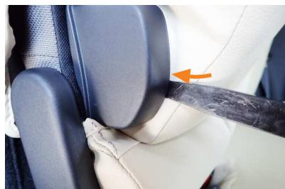
8 アームレストのヒンジ部（プラスチックパーツ）の隙間に生地を入れ込みます。
