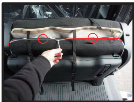
⑨シートを跳ね上げ、カバー側面に付いているヒモを、図の赤線のように沿わせ、カバー裏側に付いているループ状のガイド（図の○部）に通し、固定します。※固定方法は巻末のヒモの結び方を参照して下さい。
