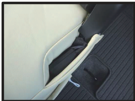
⑦シートベルト収納部の形にカバーの生地を合わせます。
