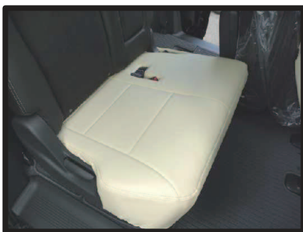
⑫カバーのラインを整え、2列目運転席側座面の完成です。助手席側も一部形状が異なりますが同様に取り付けます。
