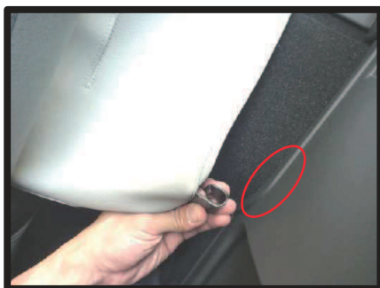
②シートの底面を見ると、図のようにシート本体の生地がプラフックで固定されている場所があります。
