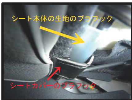
③シート本体の生地を固定しているプラフックの上から、カバーのプラフックを引っ掛けて固定します。
