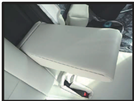
⑦タンブルシートの2列目センターアームレストは、カバーをかぶせてブラックで固定します。
