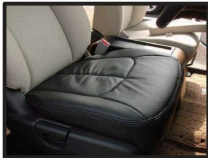
⑪カバーの表面を整え、1列目座面の完成です。助手席側も同様に取り付けます。
