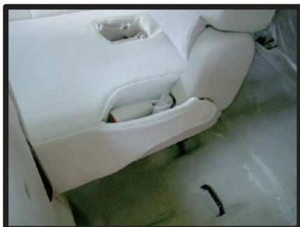
⑥シートベルト収納部分の形に合わせてシートカバーをかぶせます。
