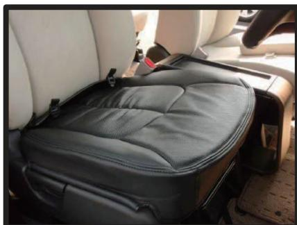
③シート前側のラインにカバー前側のステッチ部分が合うように表面を整えます。
