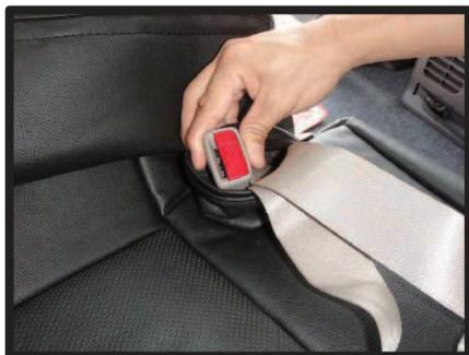
①カバーをかぶせる前に、カバーのシートベルト位置にある、筒状の生地からシートベルトを取り出します。
