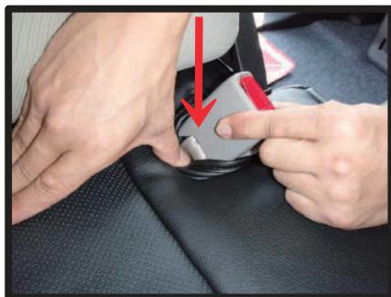
⑥シートベルト部の筒状の生地をシートの奥（図の矢印の方向）に入れ込みます。
