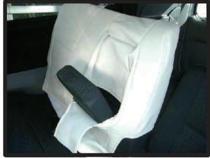
①背もたれカバーを1列目と同様にかぶせます。センターアームレストは写真のように穴の部分に通しておきます。
