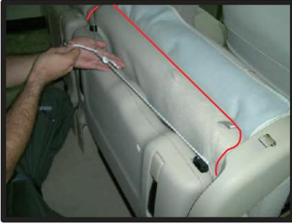
⑦座面を跳ね上げ、1列目座面と同様に固定します。赤い線のようにヒモを沿わせ、カバー裏側に付いているループ状のガイドにヒモを通し、引き絞って固定します。
