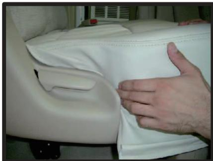
④座面外側の側面はプラスチックカバーの中にシートカバーを入れ込みます。
