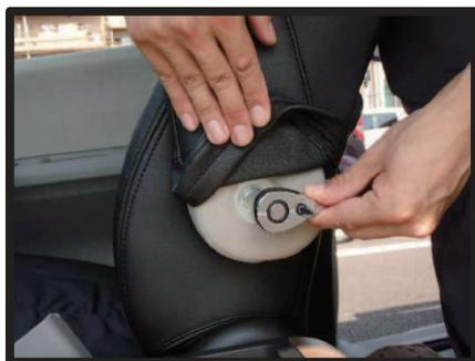
②アームレスト内側のみ、最後までカバーをかぶせた状態で、図のようにアームレストを取り外した逆の手順で、背もたれに取り付けます。
