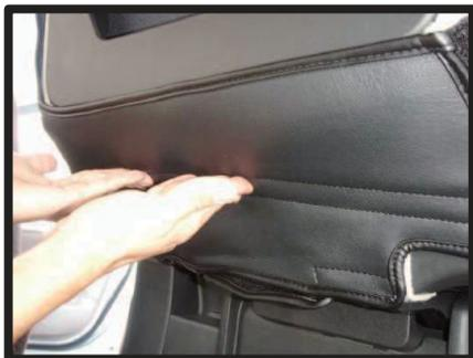
⑬図のように、マジックテープの付いている生地は、シートに直接固定していきます。
