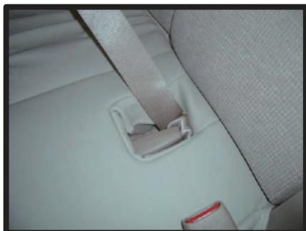
③シートベルトを穴から取り出してシートカバーを凹みの形に合わせます。
