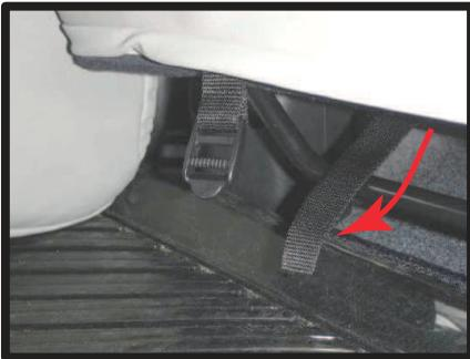
⑨シート下からベルトを取り出し、カバー前方で1列目と同様に固定します。※ベルトは図のようにシートスライドバーの上側を通して下さい。
